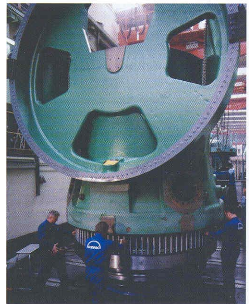
5-MW-Planetengetriebe Typ AEROGEAR für eine Windkraftanlage
